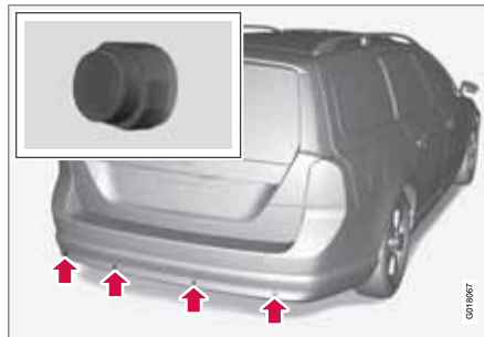
Emplacement des capteurs arrière.
