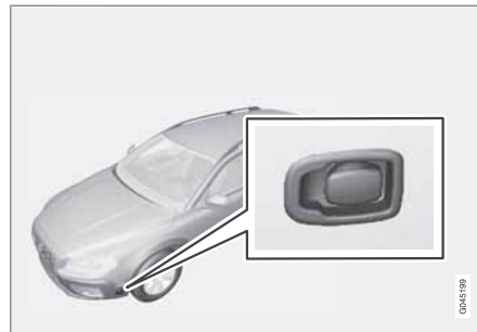
Prise électrique du chauffe-moteur.
