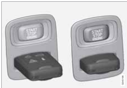
Contacteur d'allumage avec télécommande retirée/insérée.
