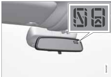
Rétroviseur avec boussole.
