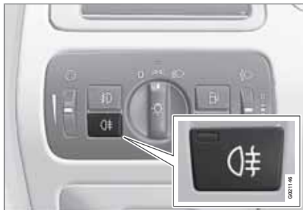
Bouton pour le feu antibrouillard arrière.
