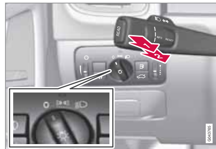
Commutateur d'éclairage et levier au volant.
