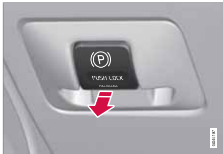
Commande de frein de stationnement - desserrage
