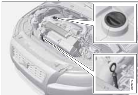
Jauge et tuyau de remplissage.
