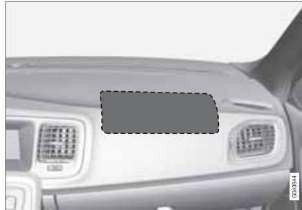
Emplacement du coussin gonflable du côté passager dans les voitures à conduite à gauche.
