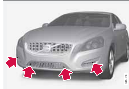
Emplacement des capteurs avant.
