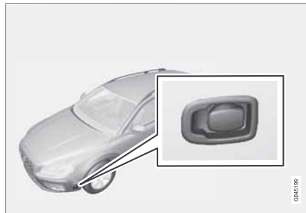
Prise électrique du chauffe-moteur.
