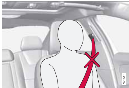
Ceinture de sécurité mal placée. La ceinture doit se trouver sur l'épaule.
