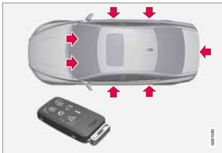
Points de verrouillage de la télécommande avec lame de clé.
