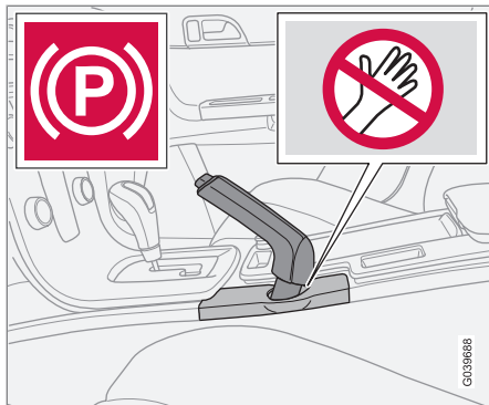
Témoin d'avertissement du tableau de bord et autocollant d'avertissement de risque de pincement.
