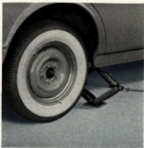
3. Soulevez suffisamment la voiture de façon à ce que la roue ne touche plus le sol. A côté de chaque roue, devant les roues arrière et derrière les roues avant, il y a une fixation dans la carrosserie dans laquelle le cric doit être placé. Le cric est manoeuvré à l'aide de la clé de cric et de la manivelle des écrous de roues.
