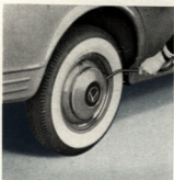
1. Enlevez les enjoliveurs à l'aide de la manivelle des écrous de roues.
