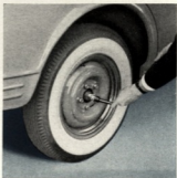
2. Desserrez les cinq écrous à l'aide du même outil.
