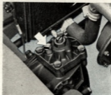
Bouchon de remplissage du boîtier de direction.
