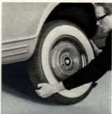
4. Dévissez les écrous complètement et enlevez la roue. Montez la roue de secours. Revissez les écrous petit à petit, une fois tous les deux écrous. Ne bloquez pas les écrous trop fortement pour ne pas endommager les disques de roues et le filet des écrous.
