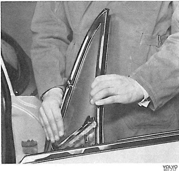
Figure 20. Dépose du déflecteur, avec encadrement
