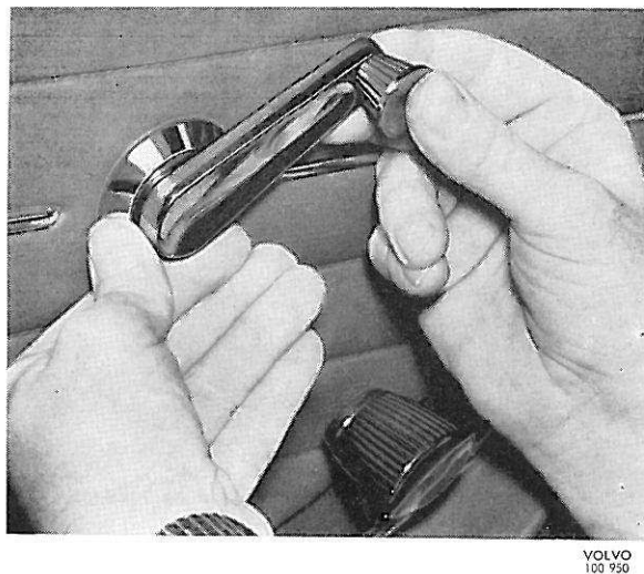
Figure 7. Démontage de la manivelle du lève-glace de nouveau modèle
