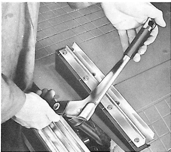
Figure 113. Démontage du levier de frein à main, P 120
