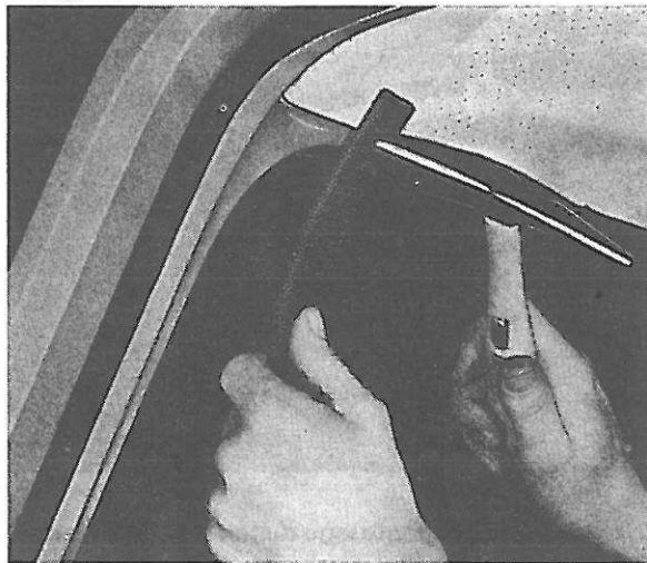
Figure 45. Ajustement de l'attache de la garniture du toit
