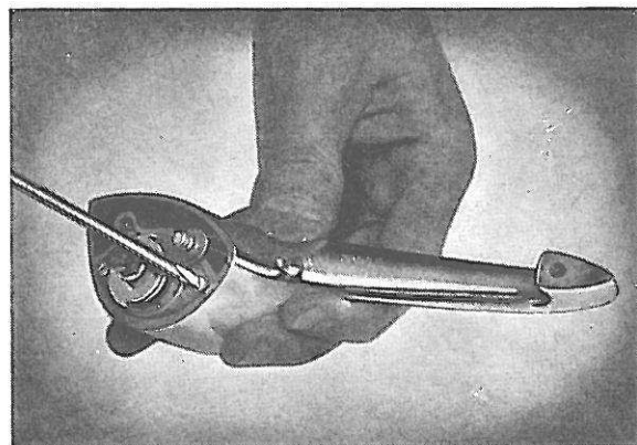
Figure 23. Démontage de la poignée de verrouillage
