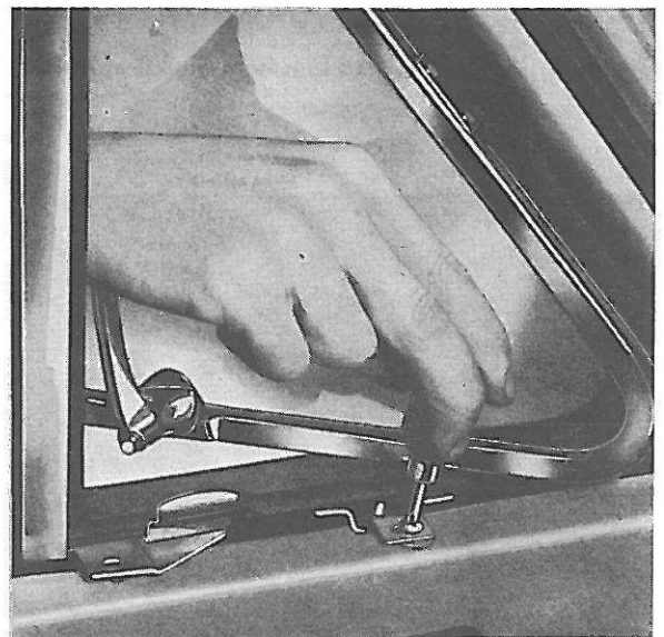
Figure 30. Vis de fixation du déflecteur
