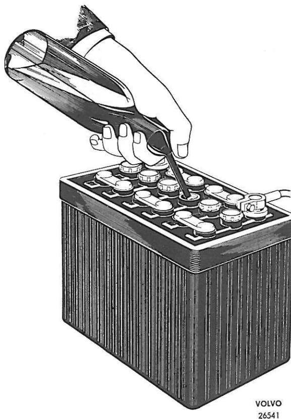
Figure 12. Rétablissement du niveau d'électrolyte de la batterie
