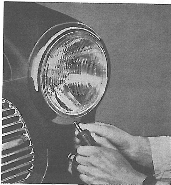
Figure 76. Démontage de la bague extérieure du phare
