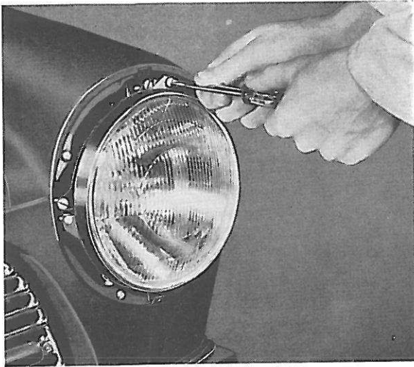
Figure 77. Démontage de la bague de retenue
