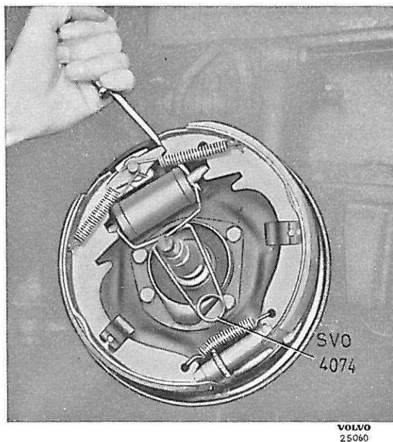
Fig. 47. Dépose d'un cylindre récepteur.
