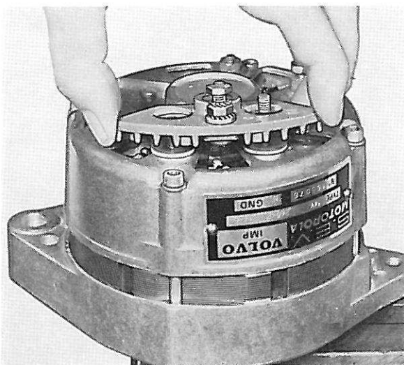
Figure 10. Démontage du porte-diode d'isolement
