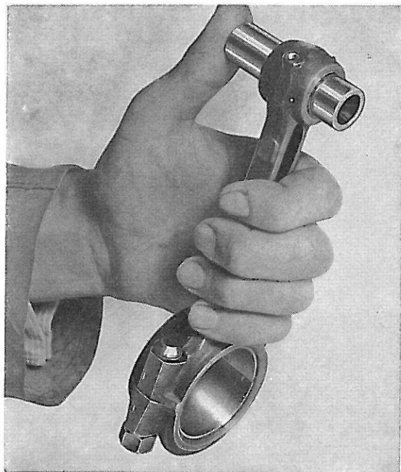
Figure 41. Ajustement de l'axe de piston
