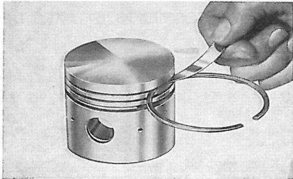
Figure 39. Mesure du jeu segment-gorge
