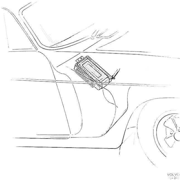
Figure 2—7. Unité de commande en place, 1800
