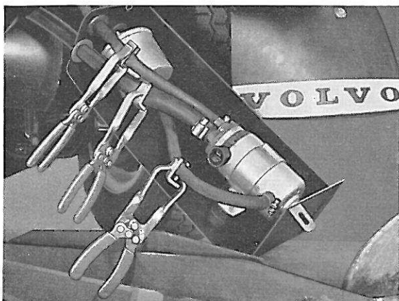
Figure 2—52. Remplacement de la pompe à carburant, 140
