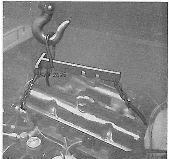
Figure 9. Dépose du moteur
