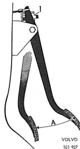
Figure 7. Course de pédale d'embrayage, 140 (ancien modèle)
