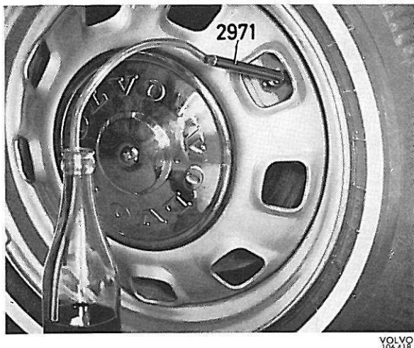
Figure 72. Purge avec un appareil de purge
