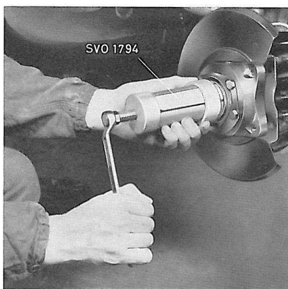
Figure 26. Démontage du roulement intérieur
