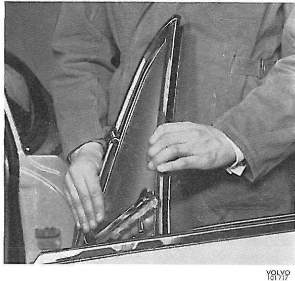
Figure 28. Dépose du déflecteur, avec encadrement
