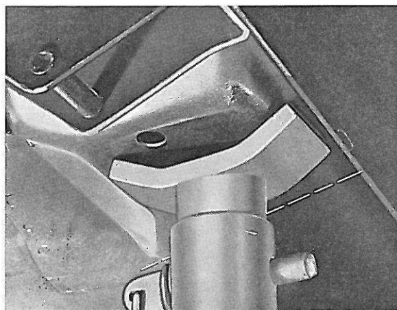
Figure 5. Emplacement de la chandelle lors du levage du train arrière
