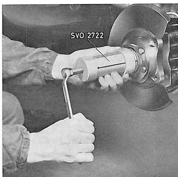
Figure 25. Démontage du roulement intérieur
