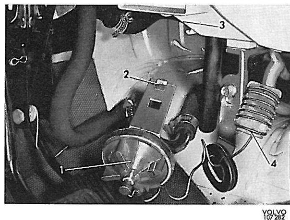
Figure 44. Echange de la valve de contrôle de température
