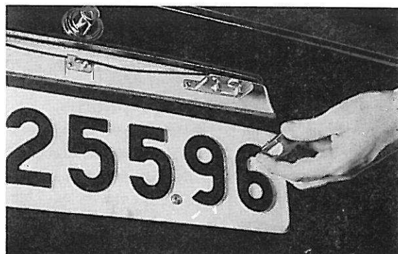
Figure 115. Eclairage de plaque d'immatriculation, remplacement des ampoules, 142 et 144
